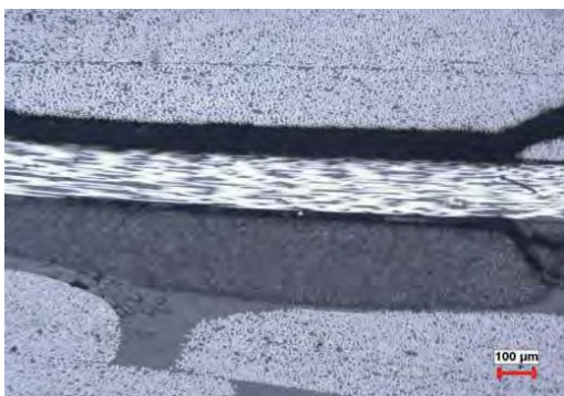
Bild 15: Schliffbild mit Grenzflächenschädigung; 50x
