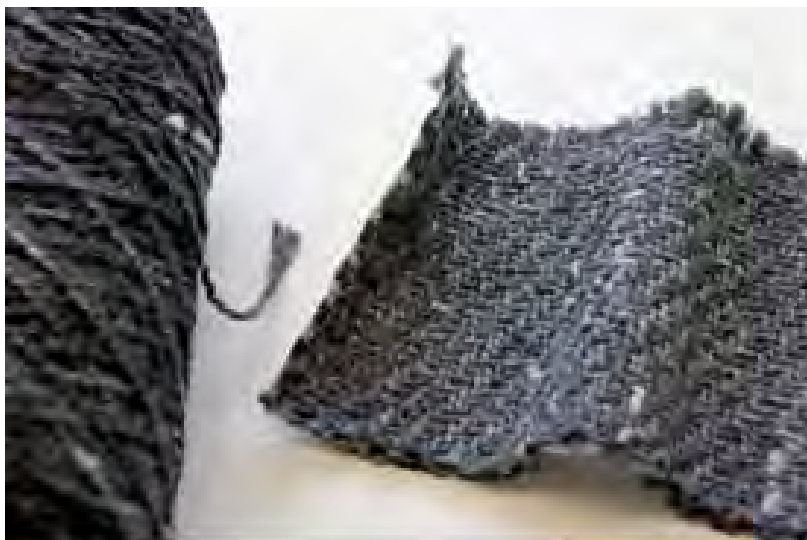
Bild 6: Carbon-PET-Garn (links) und -Gewebe (rechts) auf Rezyklatbasis [17]
