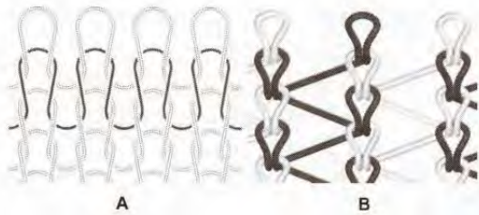
Bild 7: schematische Darstellung, Faser Gesticke A/ Faser Gewirke B
