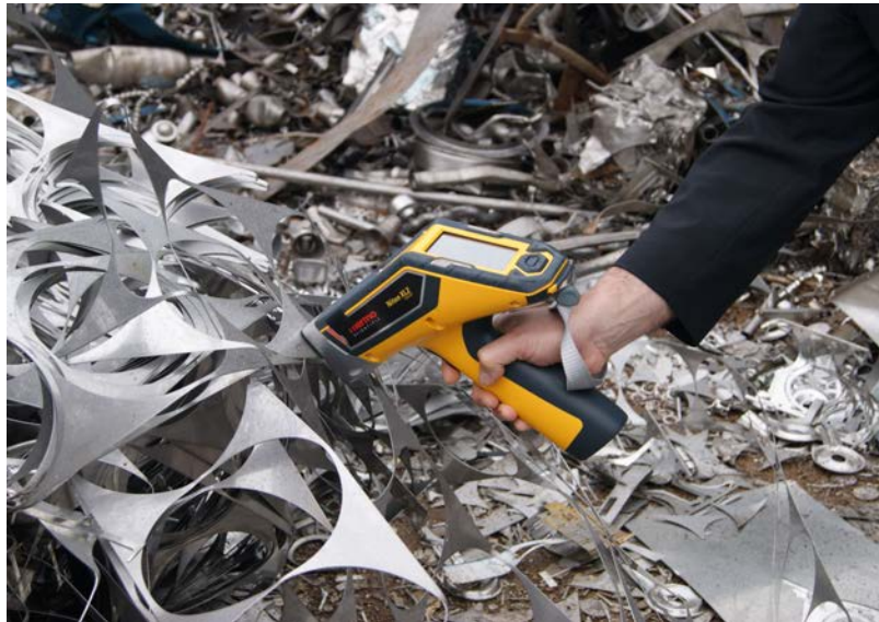
Abbildung 3: Schrottsortierung mit mobiler RFA bei der RPS Siegen GmbH /4/
