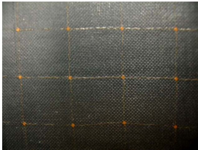
Abbildung 3: CFK-Struktur mit eingebettetem Sensor-Aktor-Netzwerk zur Schadenerkennung und Restlebensdauerprognose [3]
