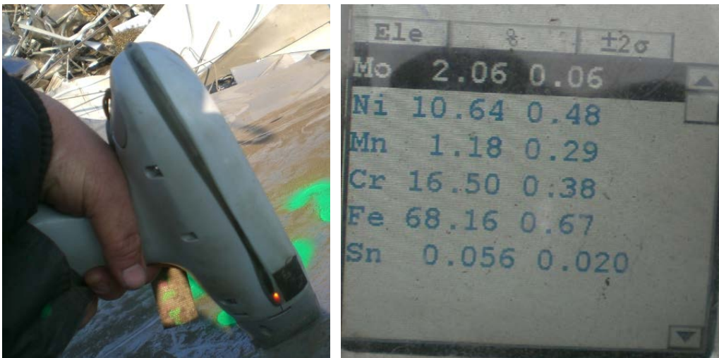
Abbildung 3: Messung mittels Röntgenfluoreszenz-Spektrometer
